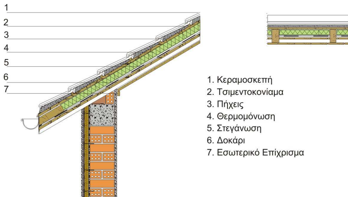
Σχήμα 3.3. Θερμομόνωση εσωτερικά σε ξύλινη στέγη
